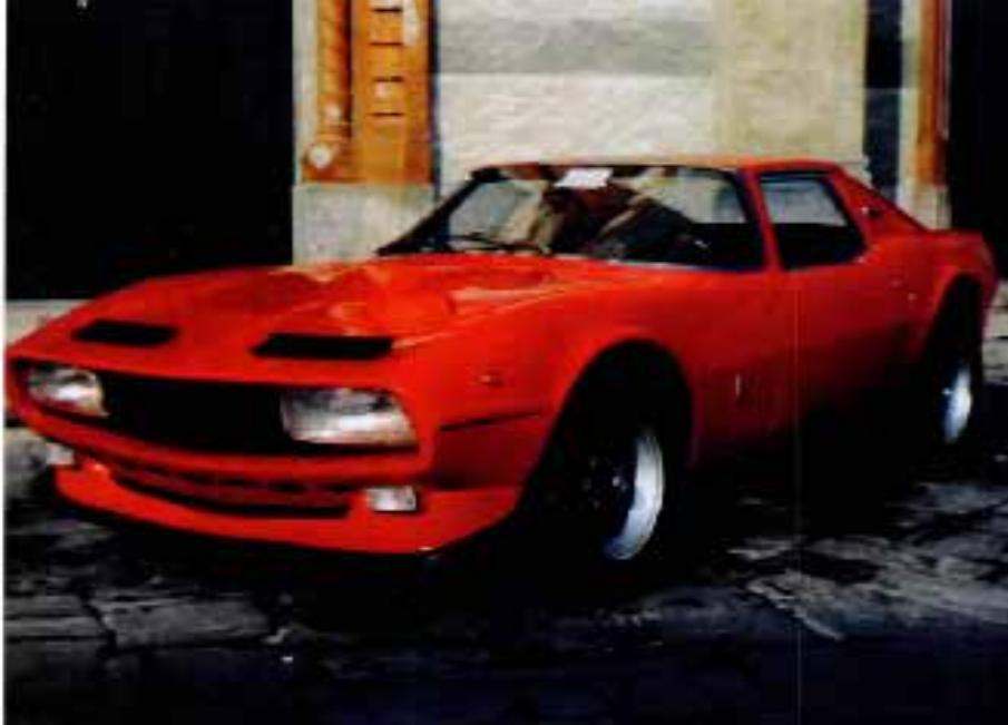
Rispetto al modello presentato nel 1968 la vettura del nostro servizio è priva del paraurti posteriore, della massiccia cornice cromata con funzione di paraurti anteriore e della cromatura orizzontale a metà della calandra. Sono stati invece aggiunte due griglie nere, lo spoiler anteriore e i fanalini posteriori della retromarcia, mentre il coperchio del cofano ha un rigonfiamento per alloggiare il sistema di sovralimentazione di cui questo esemplare è dotato.
